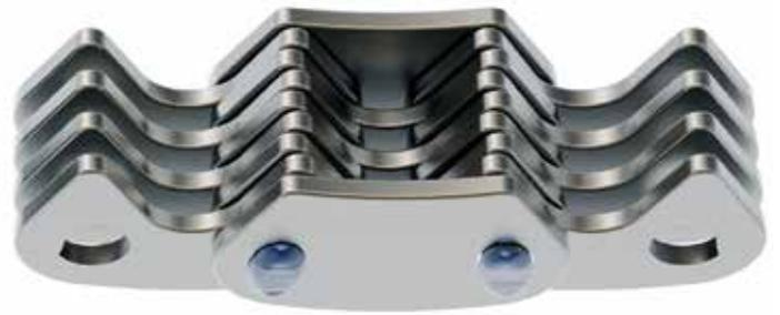
PPVシリーズは2,000 m/分を超える速度と動力に対応出来る、高性能の逆歯形状のチェーンです。他の高性能チェーンと同じ又は、それを超える能力を持つチェーンとして特別に開発され、他社のものと互換性を持っています。3/8” 及び、1.2” ピッチで幅6”迄のがあります。注意：ペンパワーに使用されるスプロケットは最低21歯のものがが必要です。
