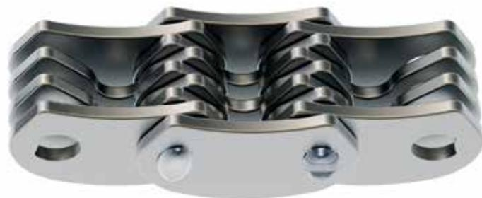
ペンパワーはペナイン社が特別に開発した高性能のサイレント・チェーンです。標準のSCチェーンの約2倍の動力があり、同じスプロケットで稼働します。スペースのない所で、高負荷で高速が要求される所に使用されます。3/8” 及び、1.2” ピッチで幅6” 迄のがあります。注意：ペンパワーに使用されるスプロケットは最低21歯のものがが必要です。
