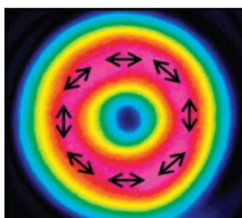
S-waveplate後の偏光ビーム強度分布(TEM01 mode) 左はラジアル、右はアジマス
