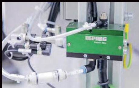
粒子除去ユニット： 粒子異物の真空除去
