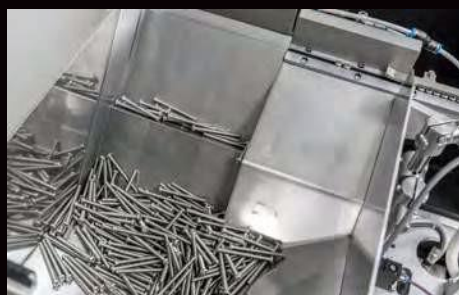
ステップフィーダー 長尺ネジにも対応
