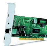
イーサネット通信モジュール
