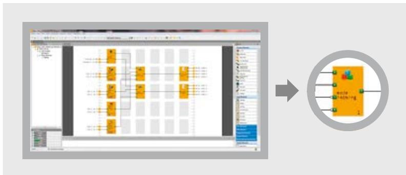
幅広いロジック接続を組み合わせで1つのマクロを構成できます。
