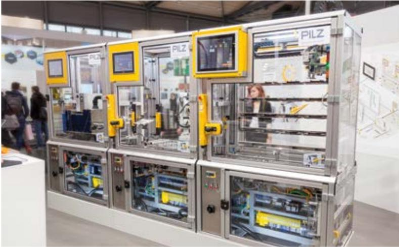
将来のオートメーションでは、制御機能を分散できる使いやすいソリューションが必要となります。オートメーションシステム PSS 4000 により、これが可能になります。同一の承認権限を持つ複数のコントローラが、リアルタイムイーサネット SafetyNET p を介して単純に接続されます。SafetyNET p は、コントローラ間でデータと状態情報を介し、それらを同期します。
