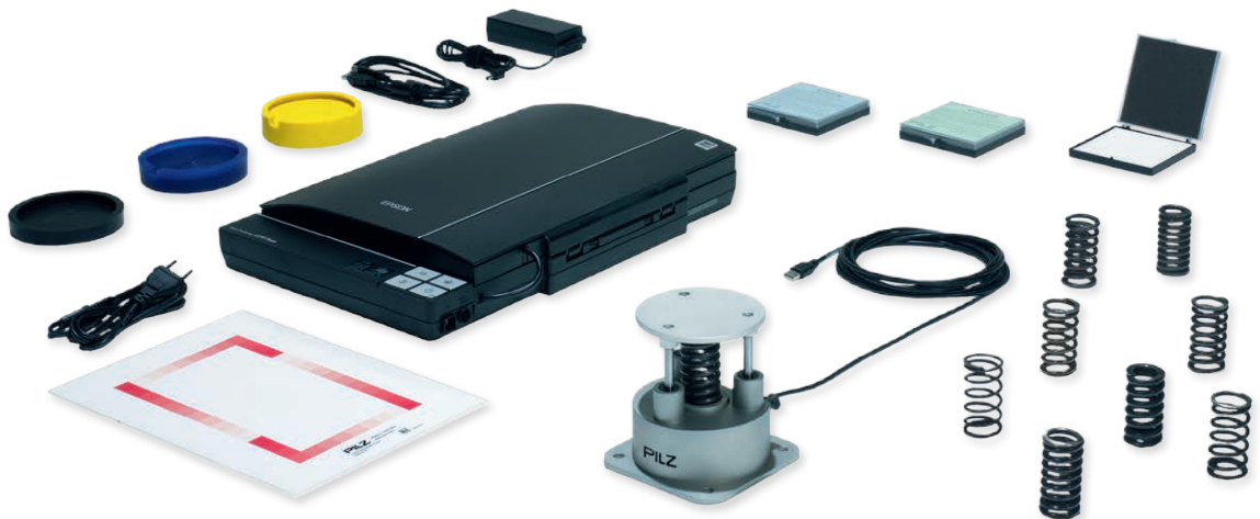
力と圧力を記録する協働ロボット用衝突測定セット。
