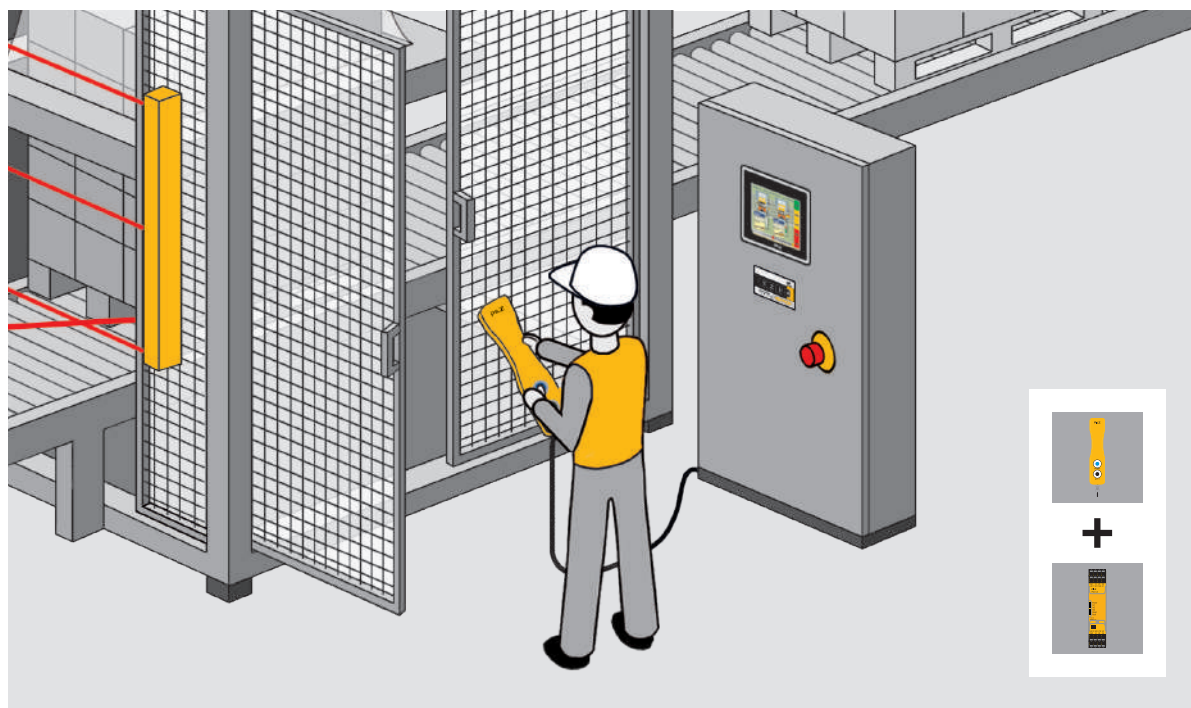
最適なソリューション：手動制御機器 PITjog および安全リレー PNOZ s6 を使用した両手監視。
