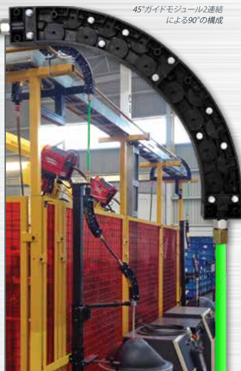
2台のロボットに対し各々設置されている180°モジュールと連続ワイヤ供給システム
