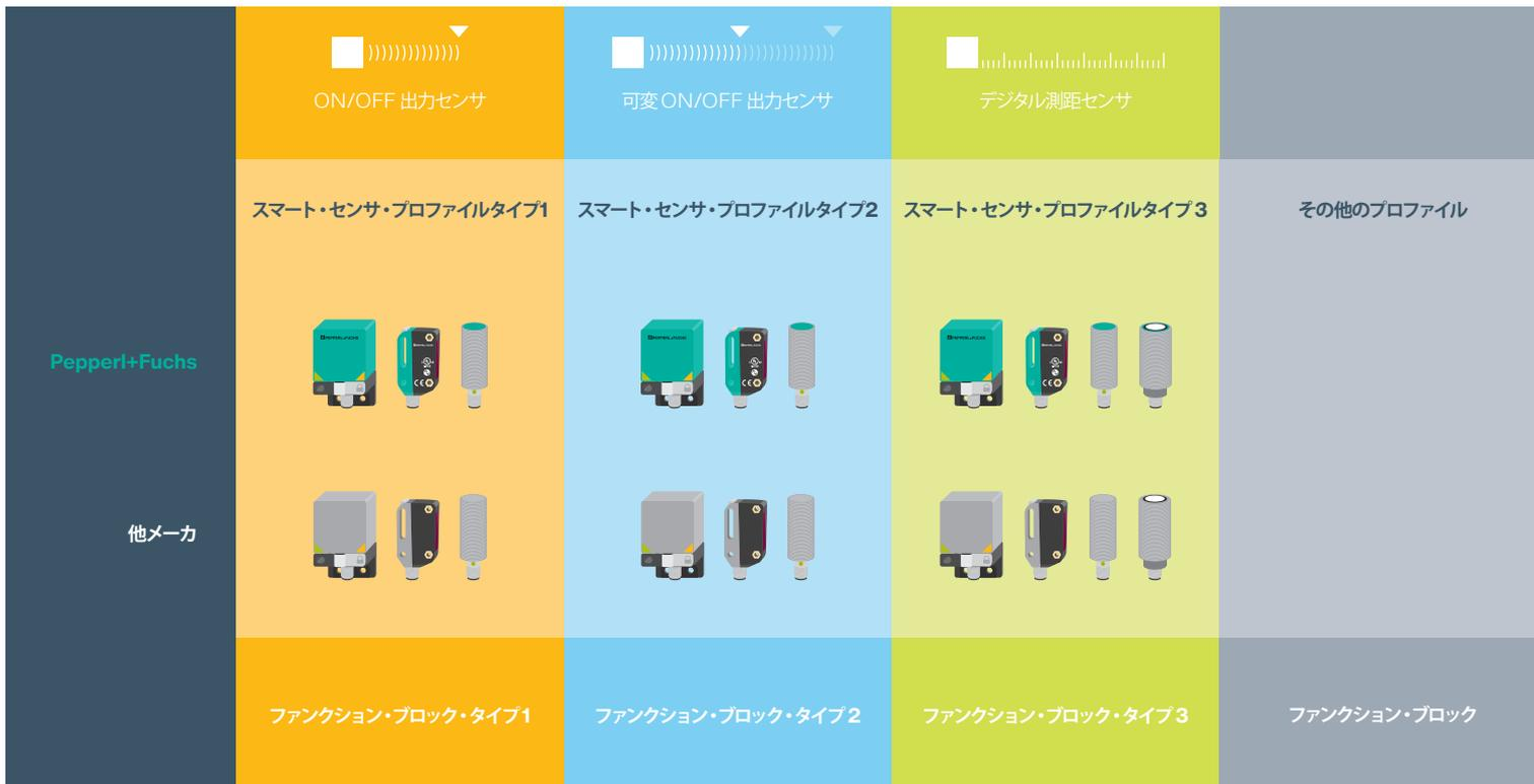
スマート・センサ・プロファイルの原理
