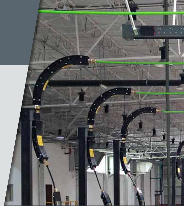
ワイヤ連続供給システム上部における 90° ガイドモジュールの設置
