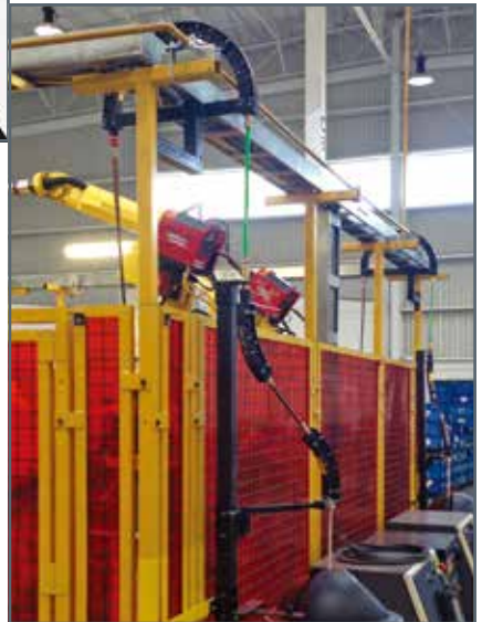
安全柵上部からの180° 構成のガイドモジュール。下にはワイヤ連続供給システムも設置
