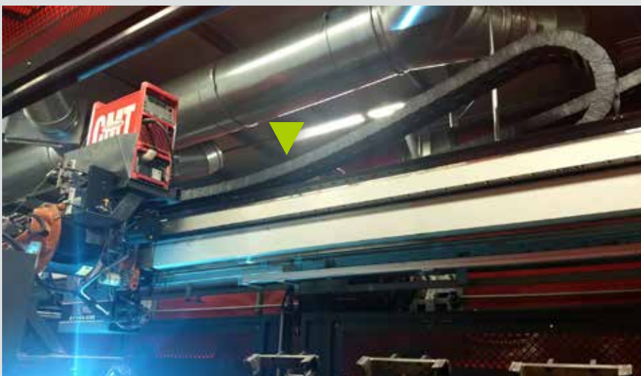
ロボット走行軸のイグス®社製ケーブルキャリア内に設置されたガイドモジュールフレックス。 Photo courtesy of PA Robotics.
