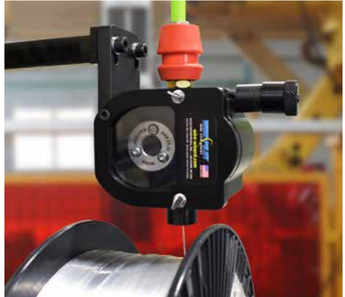
アルミワイヤスプール付きWGM-PFA-STANDに搭載されたワイヤフィードアシストと、セラミックインレット付きPFA-35インレットガイド。
