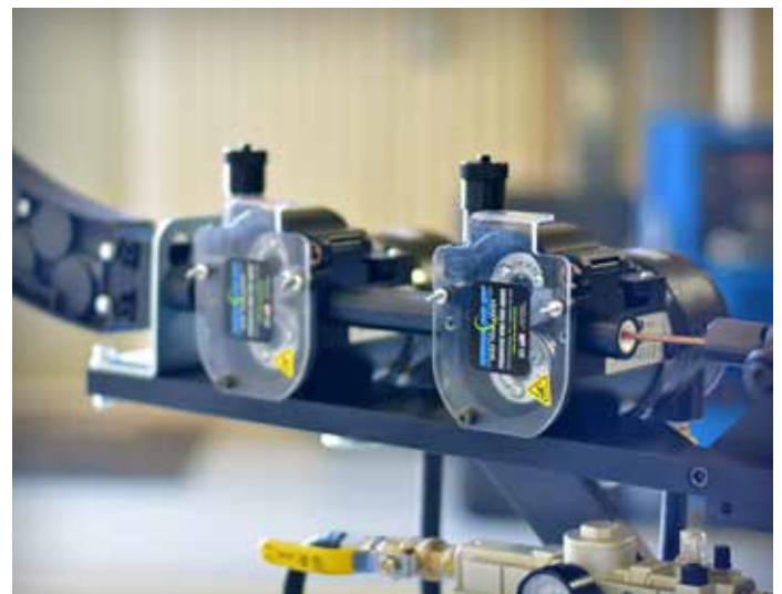
メカニカル回転テーブルに設置されたタンデム型フィードアシスト
