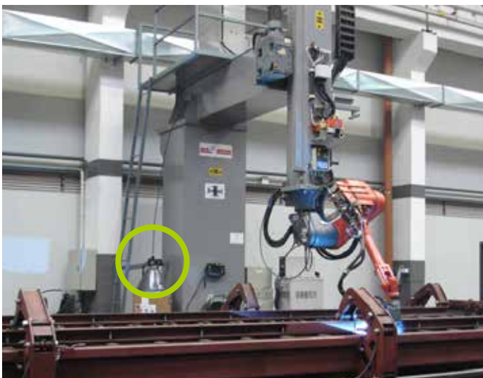
ガントリーロボットアプリケーションにて設置されたフィードアシスト
